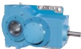
Neue Baureihe kompakter Getriebe für Industrieanwendungen. Durch die Kombination von Planetenstufen mit Stirnrad- oder Kegelstirnradstufen werden die Vorteile beider Technologien genutzt. Abtriebsseitige Hohlwellen: mit Passfedernut, Schrumpfscheibe, Innenverzahnung. Antriebsseitige Flanschverbindungen: für IEC-, Nema- und Hydraulikmotoren; elastische und hydraulische Kupplungen etc. Umfangesreiches Zubehör.
