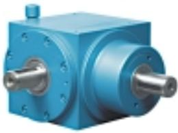
Diese Getriebe zeichnen sich durch ein stabiles, verwindungssteifes und raumsparendes Gehäuse aus. Die Radsätze aus legiertem Einsatzstahl haben Klingenberg-Zyklo-Palloid Verzahnung und werden einsatzgehärtet.
